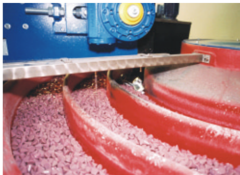
Schleifanlage zum Entgraten von Gussteilen
