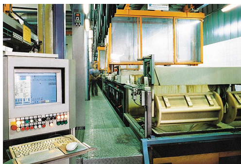
Leitstand der Trommelzinkanlage
